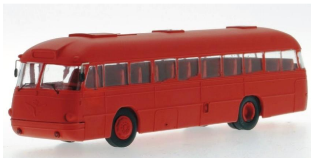
Den sidste prøvestøbning af Bussen, det vil sige, at man er klar til at gå i gang med den egentlige produktion. Foto.: Heljan.
