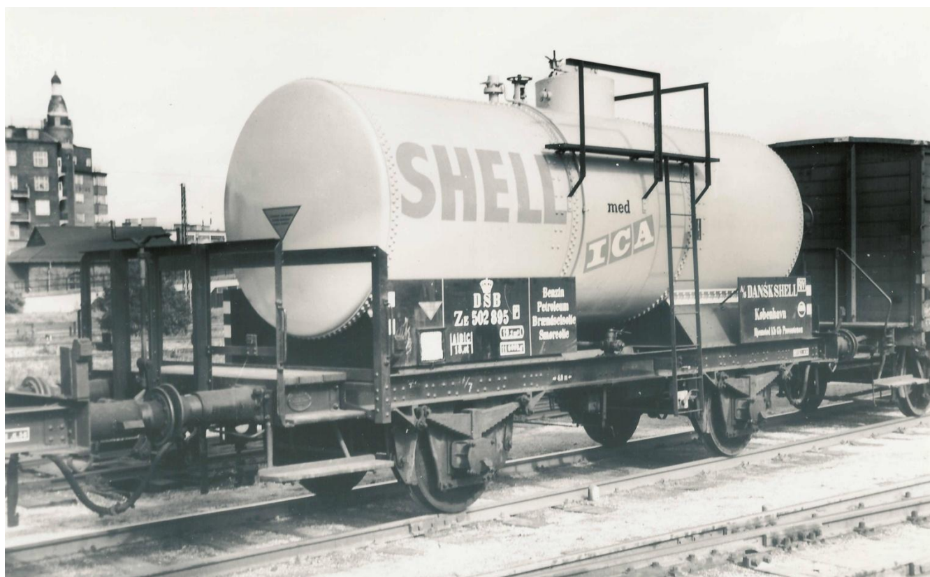
ZE 502 895. Vognen er ud af en serie på 10 vogne bygget i 1931 af Orenstein, forbillederne og modellen er så ens, at man godt kunne få den tanke, at det er lige netop denne type der er forbillede for Fleischmann modellerne. Typen blev bygget af flere forskellige fabrikker, bl.a. Wismar og Fleischmann modellen omtales ofte som en Wismar vogn. Foto.: Svend Jørgensen. Arkiv.: Nordsjællands veteranog.
