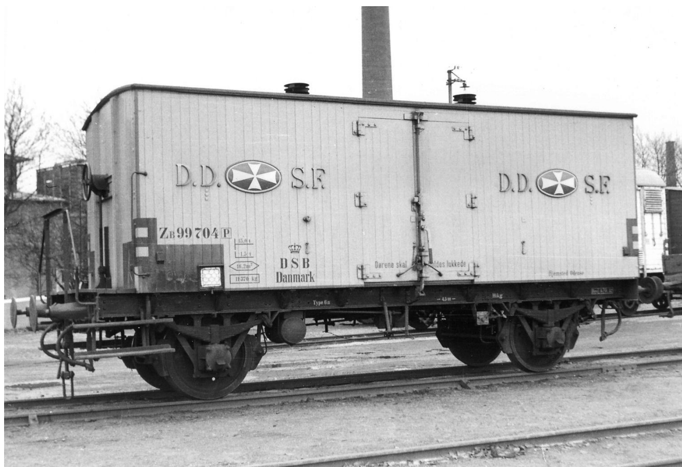
De Danske Sprit Fabrikker havde foruden en del tankvogne også en del isolerede godsvogn. De var gråmalede og udstyret med store flotte messing bogstaver D.D.S.F. og fine ovale, let hvælvet emaljeskilte (malteserkors i rød/hvid) en meget anderledes vogn at se til. ZB 99 704 er en af de udgaver, der kommer fra Hobby Trade. Billedet er taget af Poul Egon Clausen i Odense 1954. Arkiv.: DMJK.
