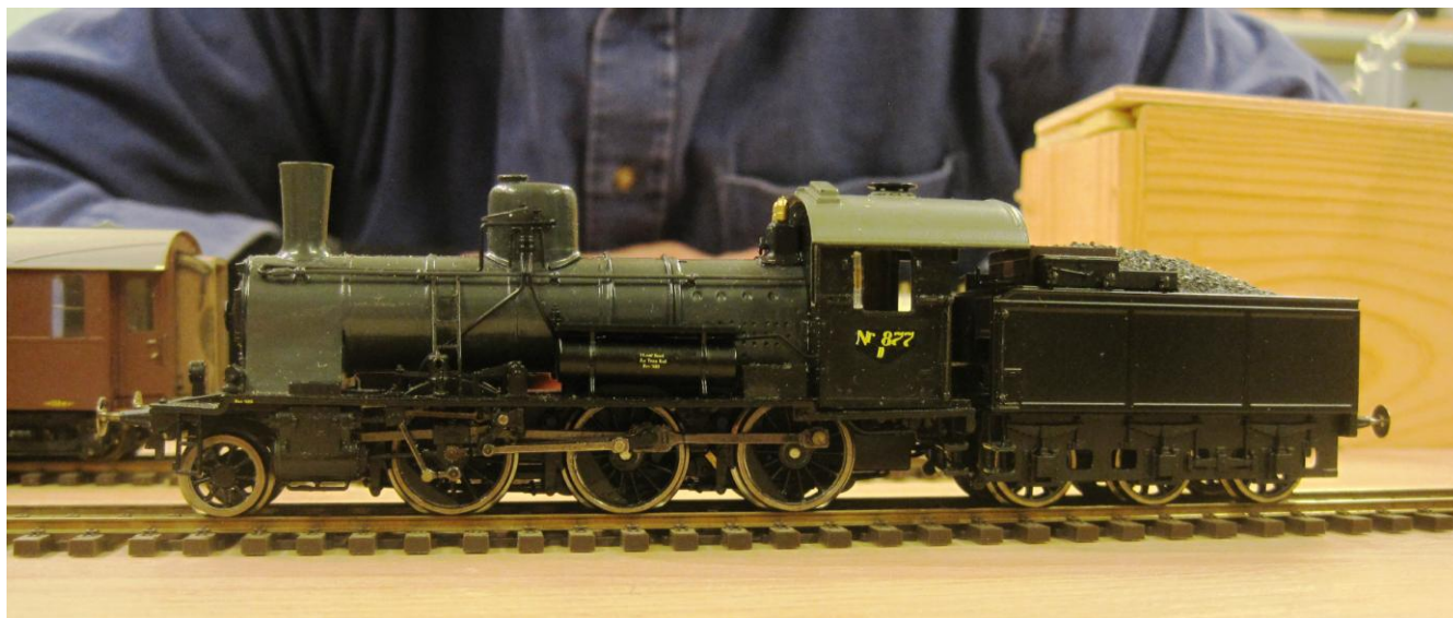
D 877 En D II ombygget fra Hobby trade D IV modellen, der er lavet ny kedel, fyrkasse, kongestol og skorsten og resultatet er da smukt!
