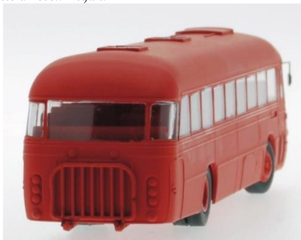
Den sidste prøvestøbning af Bussen, det vil sige, at man er klar til at gå i gang med den egentlige produktion. Foto.: Heljan.
