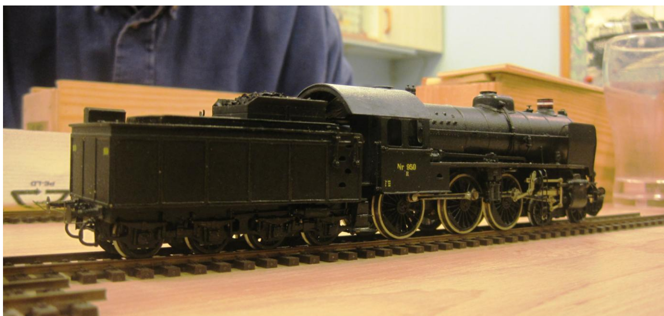
R 950. Lavet på et Jørgen Stürup ætseark og hjemmelavet, fuldt affjedret og ekvibreret undervogn, på maskine, som tender, en sjældent set og dejlig model – også Michel kan det der med drømmende øjne!
