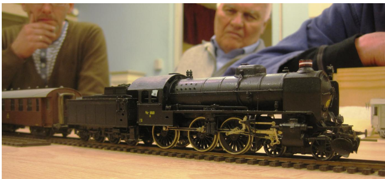
R 950. Lavet på et Jørgen Stürup ætseark og hjemmelavet, fuldt affjedret og ekvibreret undervogn, på maskine, som tender, en sjældent set og dejlig model – også Michel kan det der med drømmende øjne!
