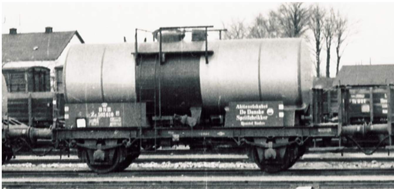
ZE 503 610 i Maribo 1958. Forbilledet for Brawa modellen, man kan bl.a. se at forstærkningen (på den nederste tredjedel af tanken), der på modellen er gennemgående – på forbilledet er der ingen forstærkning på midterste del af tanken, ellers synes jeg at tingene stemmer. Foto.: Jens Brun-Petersen.
