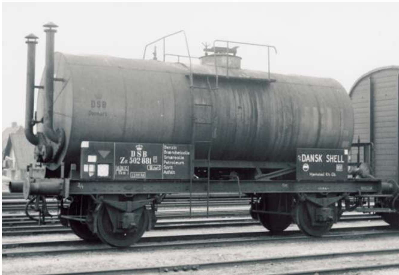
ZE 502 881. En herlig vogn, med påskrifter opsat efter 1953 forskrifterne, helt normale er de nu ikke for DSB Danmark påskriften, ligner faktisk den skrifttype man anvendte da man indførte UIC påskrifterne i midten af 1960 og her er vi altså i 1958. Bemærk i øvrigt at vognen mangler den ene halvdel af en puffer, den ligger på bremseplatformen, foran navnepladen. Arkiv.: På Spret.
