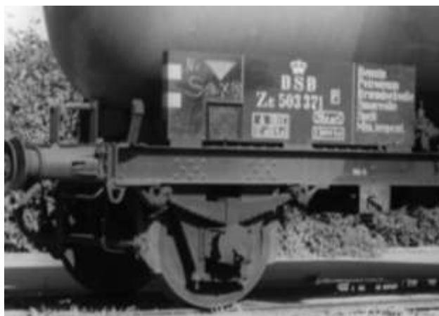
På tankvogne sad bremsemærkningen for det meste på litra og adresse pladerne, eller tanken. Arkiv.: På Sporet.
