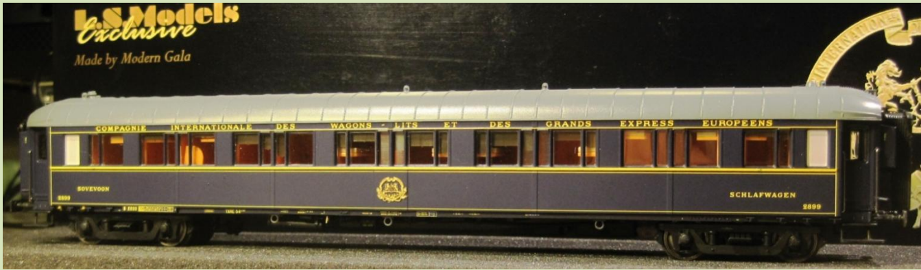
Begge sider af modellen af Type STU 2899. Øverst ses kupesiden, glaslamellerne ("Bricards") mangler, de blev fjernet på de fleste CIWL sovevogne omkring 1960. Nederst er det gangsiden og de danske påskrifter, også våbenskjoldet har dansk inskription - det er desværre en fejl, kun de 8 Scandia byggede M3 havde som de eneste et våbenskjold med inskription på et andet sprog end Fransk - nemlig Dansk!
