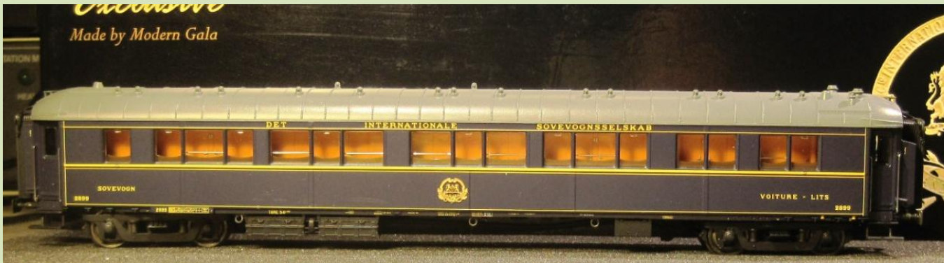
Begge sider af modellen af Type STU 2899. Øverst ses kupesiden, glaslamellerne ("Bricards") mangler, de blev fjernet på de fleste CIWL sovevogne omkring 1960. Nederst er det gangsiden og de danske påskrifter, også våbenskjoldet har dansk inskription - det er desværre en fejl, kun de 8 Scandia byggede M3 havde som de eneste et våbenskjold med inskription på et andet sprog end Fransk - nemlig Dansk!
