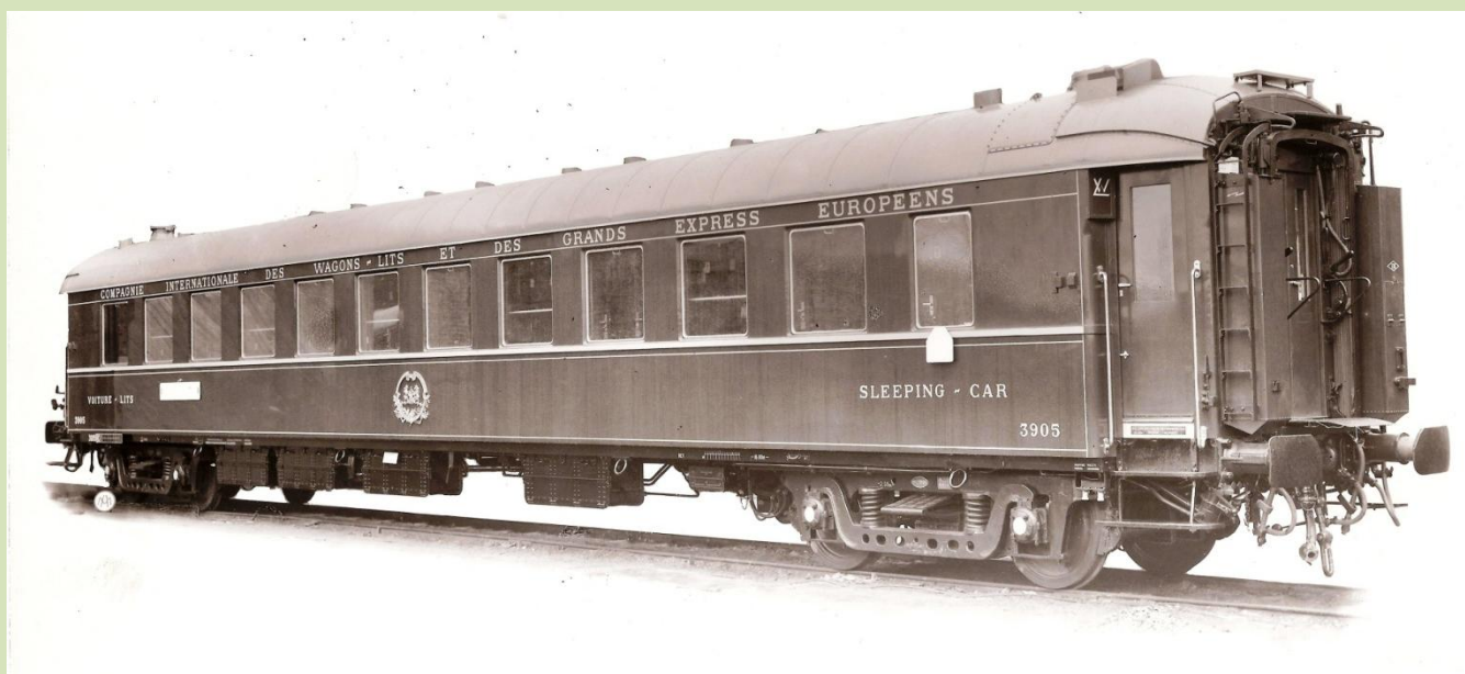
WL type Y 3905. Fabriksfoto fra Nivelles 1949, vognen kom til at køre en hel del med Danmark som stationeringssted. Den sidste type sovevogne bygget efter det grunddesign, CIWL indførte i 1922 med type S. Arkiv.: Steffen Dresler.
