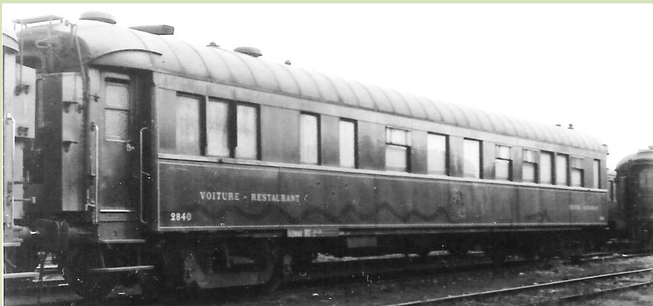
WR 2840. i Landy, oktober 1954. Køkkenside. Bemærk at de fire fjerneste store vinduer sidder med væsentligt mindre indbyrdes afstand. Foto.: Dr. W.A.C. Wendelaar. Arkiv.: Otto Dykstra.
