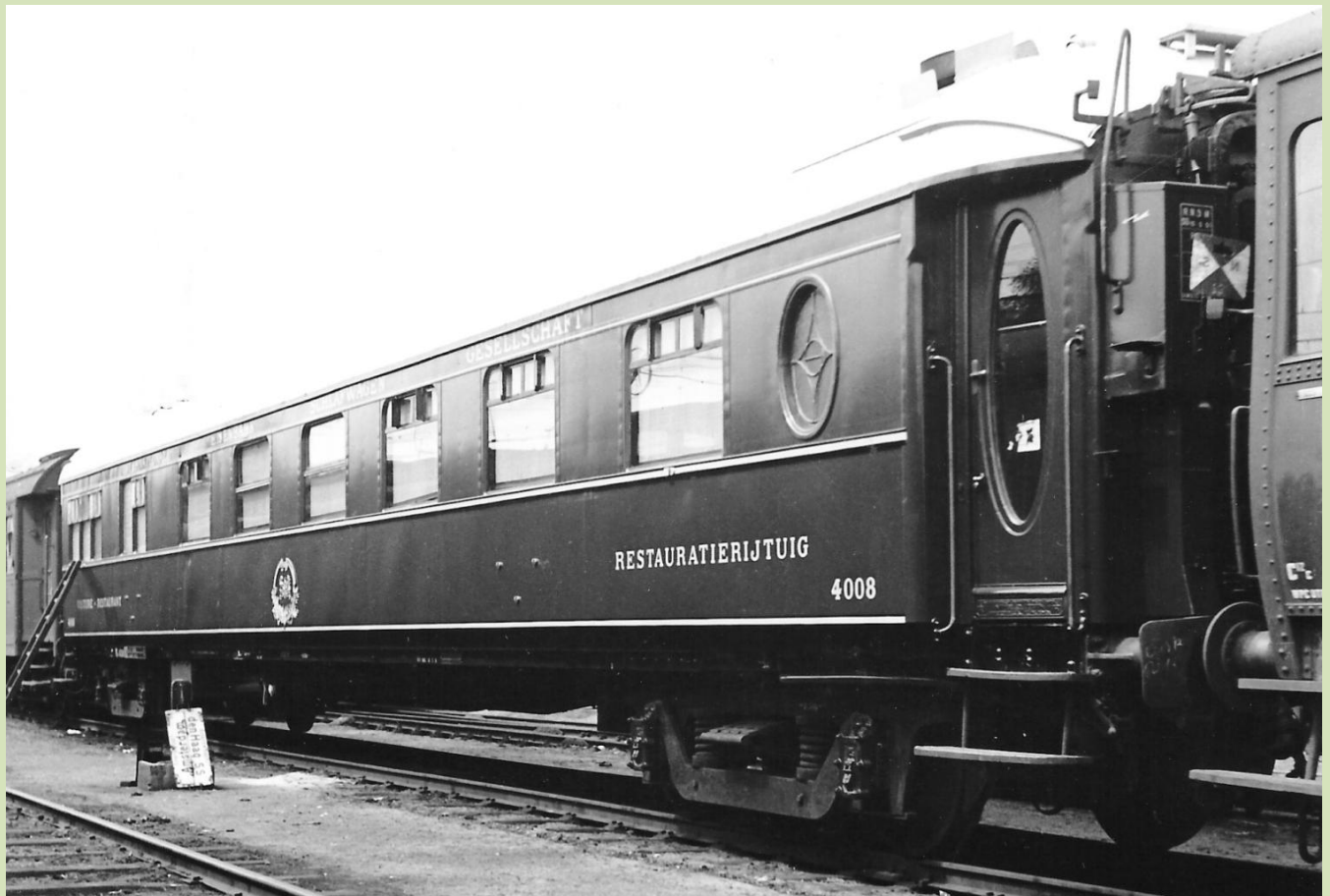
WR 4008 i Amsterdam Maj 1951. Vognen har delvis hollandsk/tyske påskrifter, det betyder, at den er stationeret i Holland. Netop vogne fra det Hollandske depot var ofte i Danmark. De "trækfri" anordninger, der sidder øverst i de store vinduer, mangler på to vinduer. Man fjernede 2 på hver side og på alle ex Pullman vogne, efter ombygningen. Foto.: W.A.C. Wendelaar. Arkiv.: Otto Dykstra.
