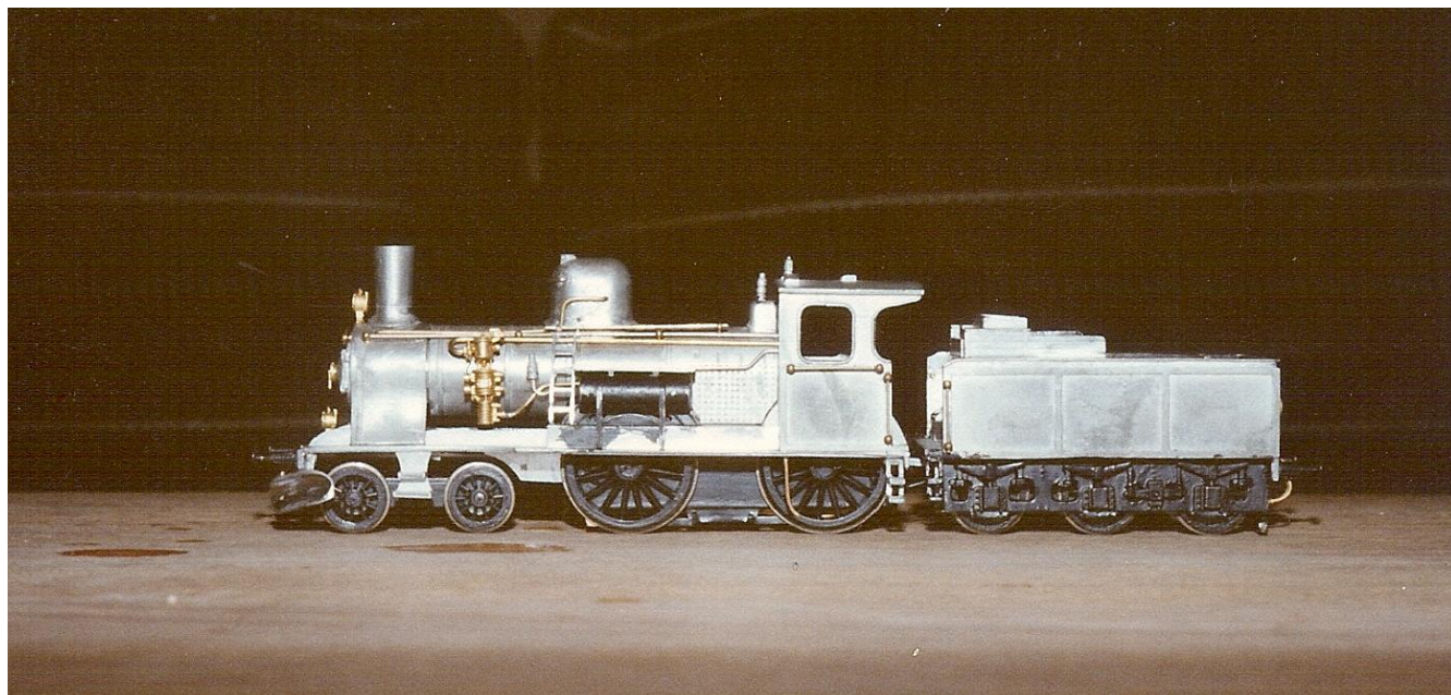
C 712 klar til at blive malet, maskinen er udstyret med et tenderdrev fra På Sporet, det tog "kun" 10 år at lave den færdig.
